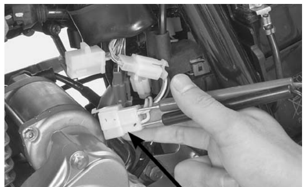
CONECTOR NO LADO DO ALTERNADOR
