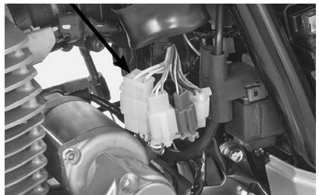
CONECTOR 3P DO ALTERNADOR
